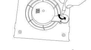
**E.** Enlevez la rondelle permettant le passage des fils électriques.
